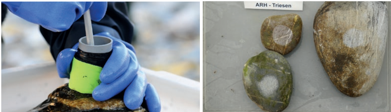
Abb. 11: Untersuchung des Kieselalgenaufwuchses. Links: Abkratzen der Probe mit Manschette und Pinsel; rechts: beprobte Flächen auf Steinen/Grobkies aus dem Alpenrhein. Fotos: HYDRA 2002, 2015 ©.
